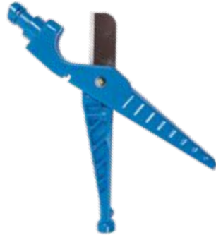
Çok Fonksiyonlu Hunter Emitör El Aleti P/N HEMT (pilot delikleri deler ve emitörlerin girmesini ve çıkmasını sağlar, boruları keser)
